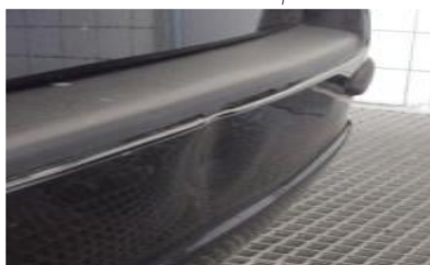
Duidelijke vervorming van de bumper
