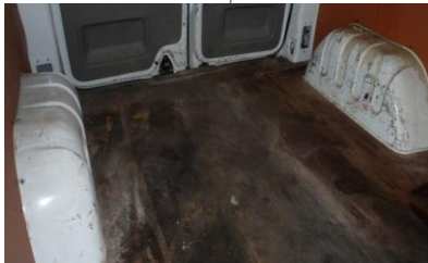
Laadruimte met lichte beschadigingen en vervuiling
