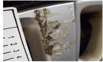
Schade als gevolg van oxidatie
