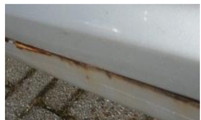
Roestschade als gevolg van schade
