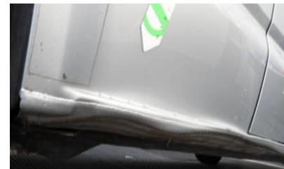
Onderzijde schade als gevolg van obstakel
