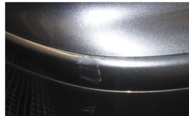
Beschadiging < dan formaat creditcard met een vervorming
