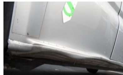
Onderzijde schade als gevolg van obstakel
