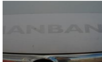
Kleurverschil na verwijderen reclame
