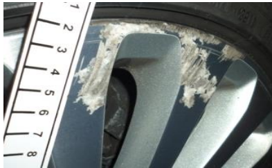
Beschadiging over meerdere spaken
