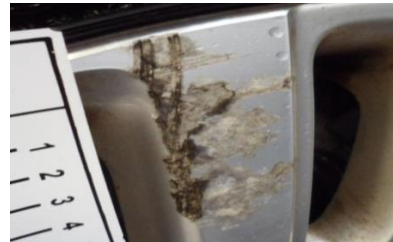
Schade als gevolg van oxidatie
