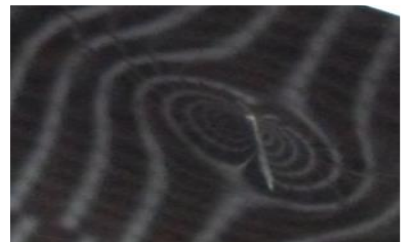
Deukje < 2,5 centimeter met lak beschadiging
