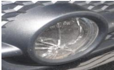
Schade aan de mistlamp als gevolg van steenslag
