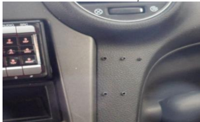
Schroefgaten als gevolg van demontage carkit
