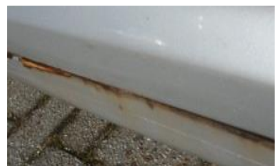
Roestschade als gevolg van schade
